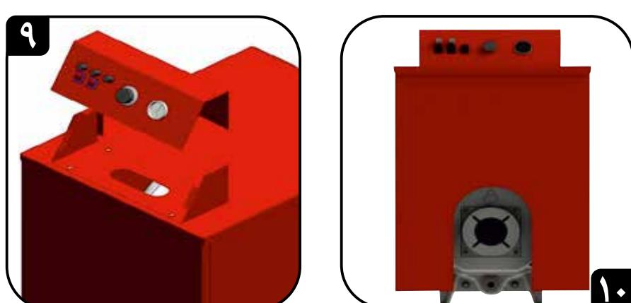
ب - پنل کنترلی را روی پایه نگهدارنده قرار دهید و توسط ۶ عدد پیچ خودکار به پایه ثابت کنید ( تصویر ۹ و ۱۰ )
